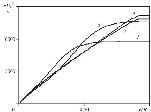
Рис. 1. Радиальные распределения безразмерного масштаба времени турбулентных пульсаций поля скорости в зависимости от продольной координаты  $x/D$ . Здесь 1 -  $x/D = 3$ ; 2 - 8; 3 - 40; 4 - 160 ( $Re = 4.25 \cdot 10^5$ )
