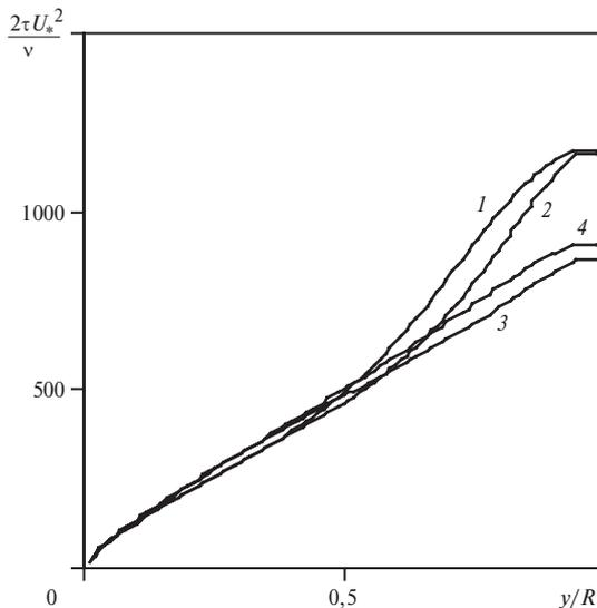
Рис.2. Радиальные профили безразмерного характерного масштаба времени турбулентных пульсаций температуры в различных сечениях по длине канала. Здесь линии 1– $x/D = 9$ ; 2–12; 3–24; 4–160 ( $Re = 3.25 \cdot 10^4$ )
