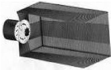
Рис. 3. Сеточная модель жаровой трубы с завихрителем
