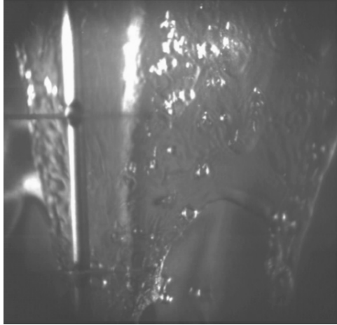
Рис. 3. Кадр высокоскоростной видеосъемки: Re_{вх}=690 , q = 1,1 \cdot 10^4 Вт/м 2 . Плёночное течение жидкого азота при наличии стабильных несмоченных зон
