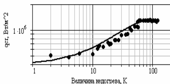
Рис. 2. Характерная зависимость КТП от недогрева для объемного кипения изопропанола при диаметре нагревателя 1.042 мм. Точки – экспериментальные данные работы [3], линия – расчёт по формулам (2)–(4)
