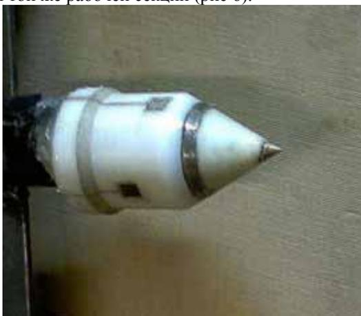
Рис. 6. Вид модели с датчиками теплового потока
