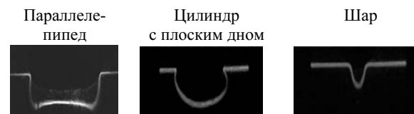
Рис. 3. Рефракционные картины для лазерной плоскости, прошедшей под дном различных объектов
